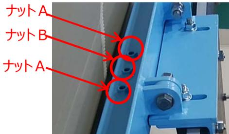
③ボルトを突っ張らせる位置を決め、枠の位置調整をします。(下流側)
