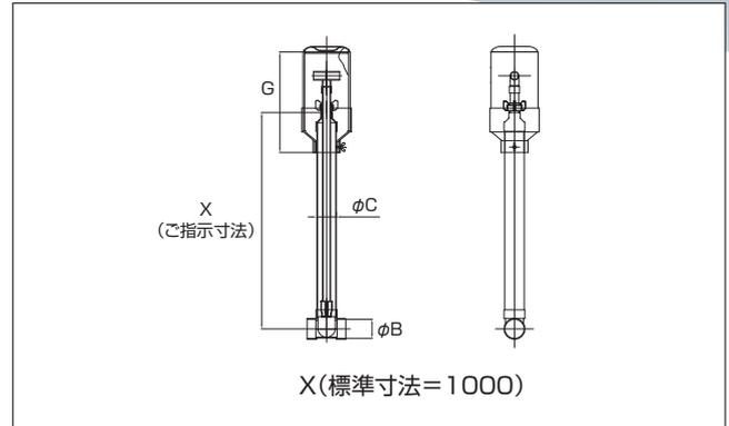
**K1WS型 水位調整孔付水平水閘(収納式)** (単位: mm)
