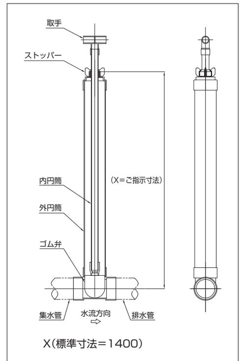
**K1CP/K1CS型 収納式水甲管** (単位: mm)
